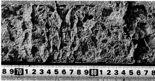
図-7 ひび割れ性状 (無補強供試体)
