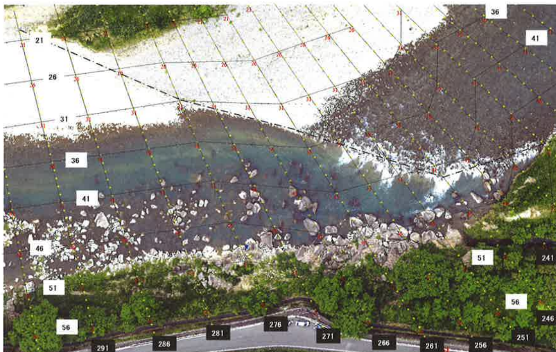
写真-4 砂礫堆の前縁・段落（一点鎖線）、巨岩群とレフュージア付近の計算格子と格子点番号。
