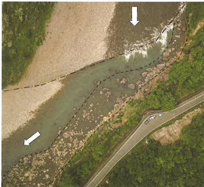
写真-2 砂礫堆前縁（一点鎖線）と その下流区間の巨岩群（点線内）
