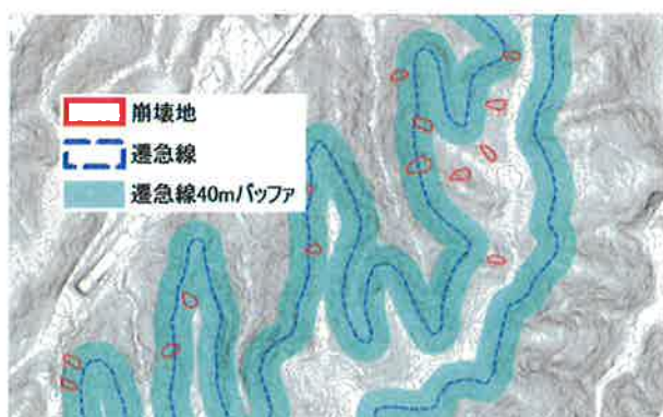
図-4. 4 相生層群 (上郡町域) における 遷急線周辺で発生している崩壊地
