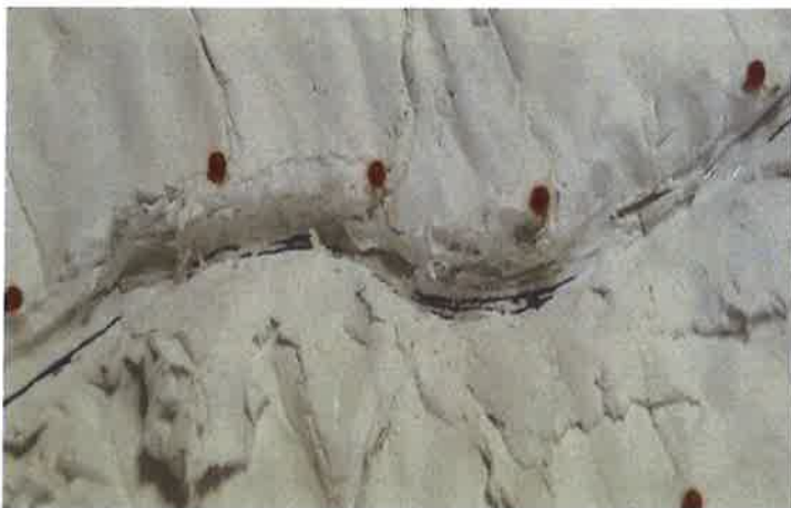
図-7.5 下陣管路の挙動
