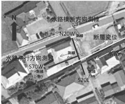
図-16 下陣水路横断箇所での表面波探査調査場所 (国土地理院 (電子国土 Web) 5) に加筆)
