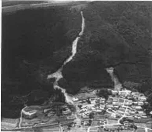
写真-1 出現した土石流（熊本県大津町立野地区） 右側は道路より発生している 8)
