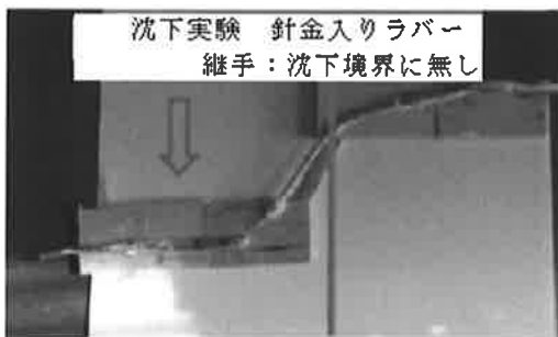
図-21 モデル④-1 掘削後変形
