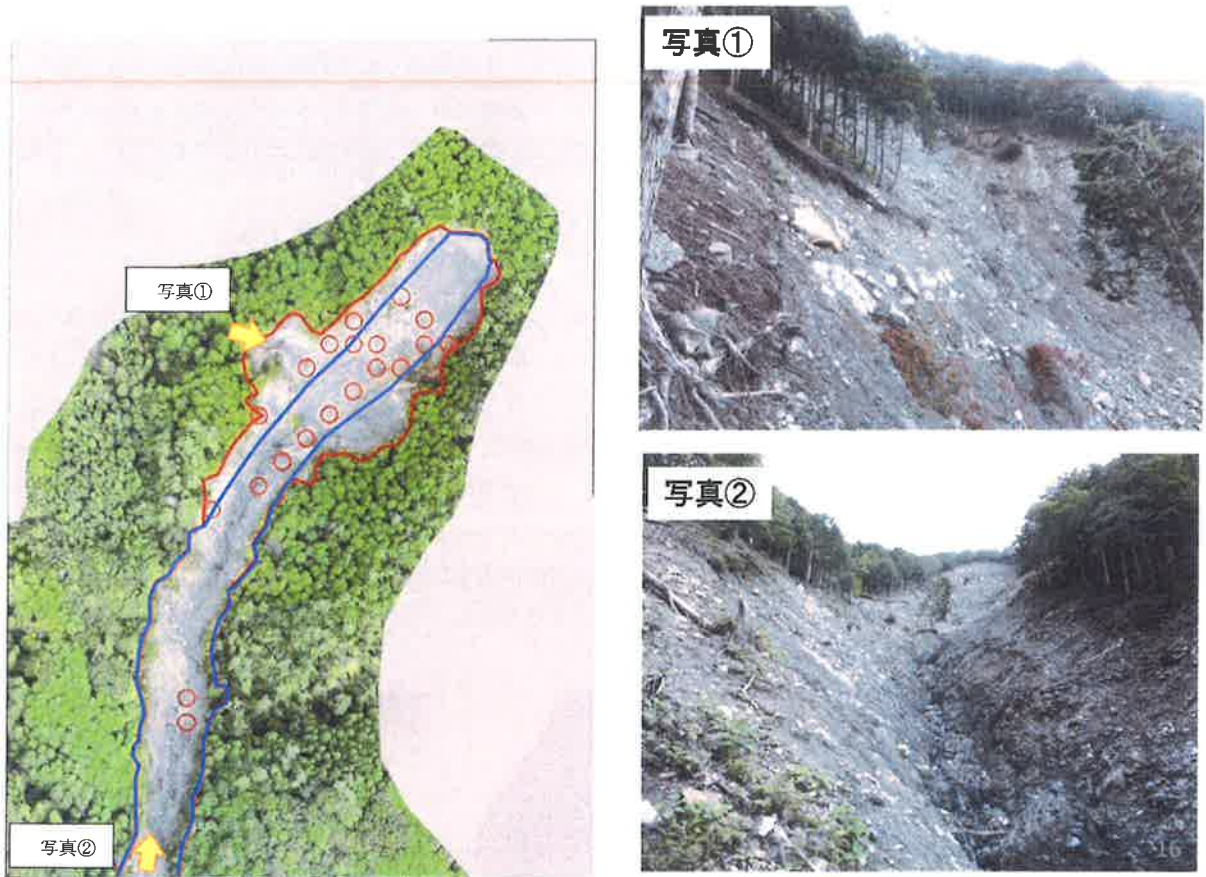
図-10 UAVで撮影した崩壊地の空中写真（青：H23年崩壊、赤：H30年に拡大した範囲）と現地状況（2018/9/7）
