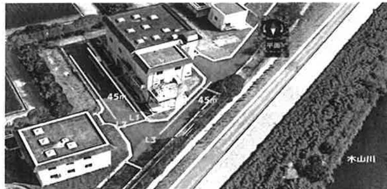
図-3.3 浄化センター敷地内の表面波探査2測線
