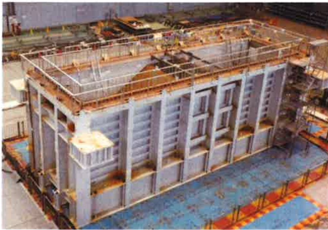
写真-1 実物大盛土実験に用いた土槽の全景
