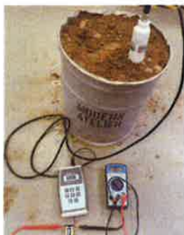
写真1 土壌水分計の計測状況
