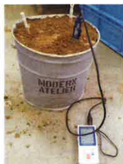
写真2 ポータブル電気伝導率計の計測状況
