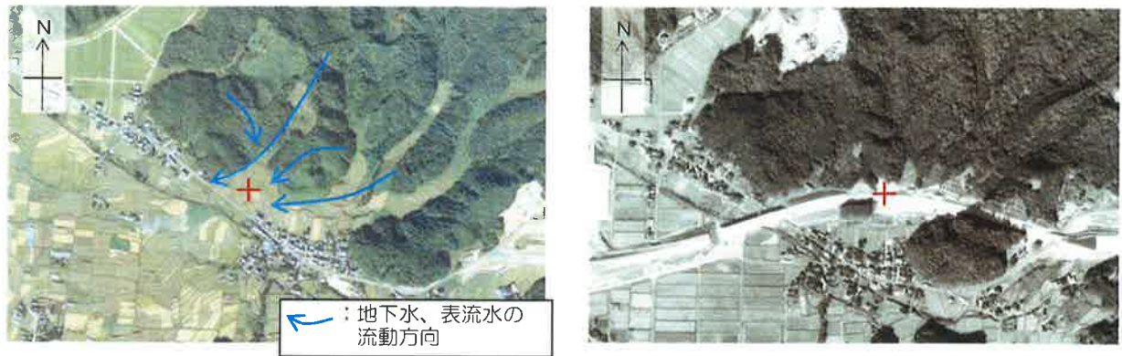
図-2 左：1976年（盛土建設前）に撮影された対象地点の航空写真，右：2005年（盛土建設途中）に撮影された対象地点の航空写真（双方とも参考文献 6) に加筆，図中+が当該盛土の地点を示す）
