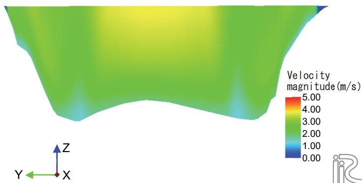
図-14 iRIC (Nays CUBE) を用いた横断流速分布 (2019 年 10 月 12 日 14:20)
