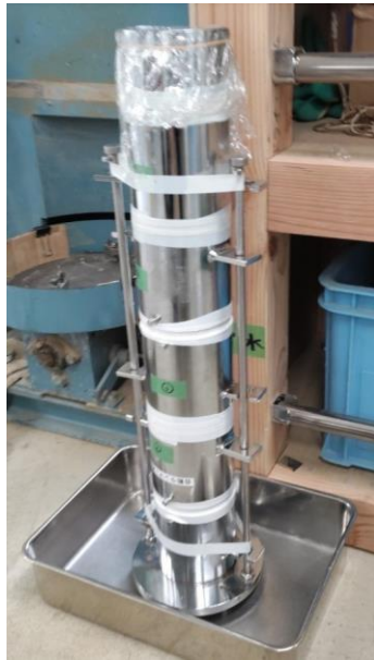
写真-4 通水試験時の様子
