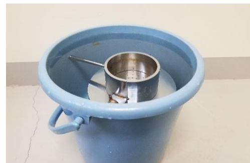
(a) 定水位透水試験用供試体
