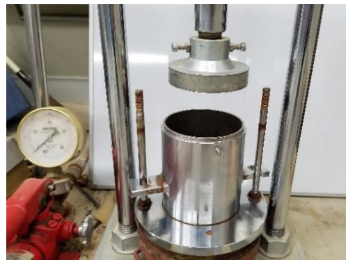
写真-2 油圧ジャッキによる静的締固めの様子
