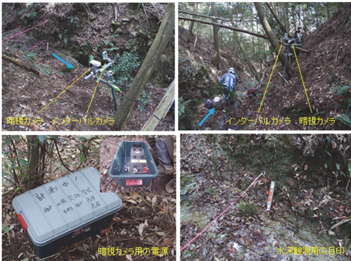
図-5 Webカメラ(暗視)とタイムラプスカメラの設置状況
