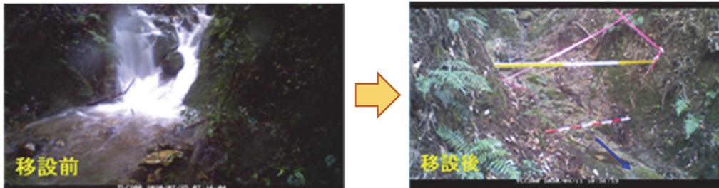
図-4 カメラの移設 (直線流路で流下断面形状が単純な矩形となうようにカメラを上流へ移設, 目印を設置)
