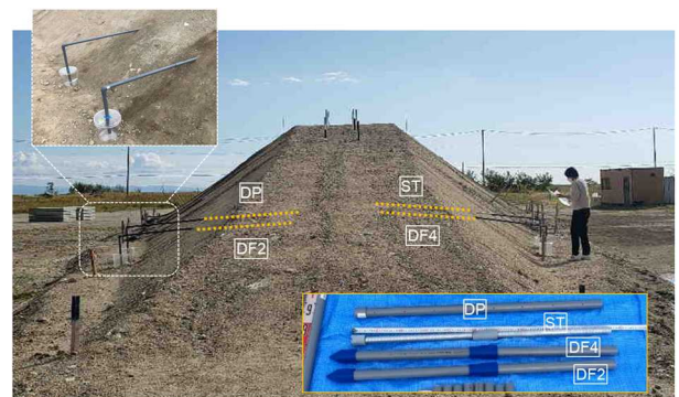
写真-2 排水工設置概要
