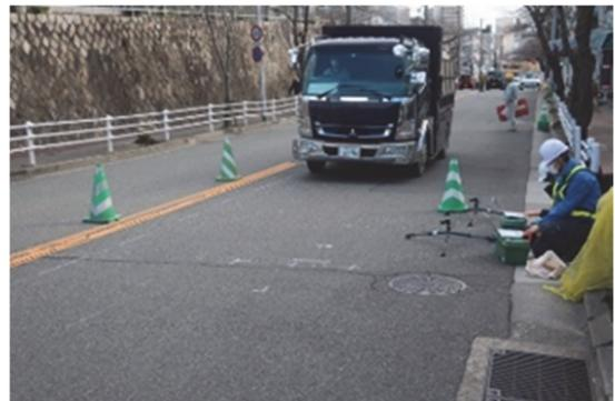
写真-2.1 車両輪荷重による計測状況
