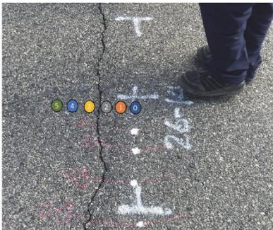
写真-2.3 輪荷重によるたわみ計測状況
