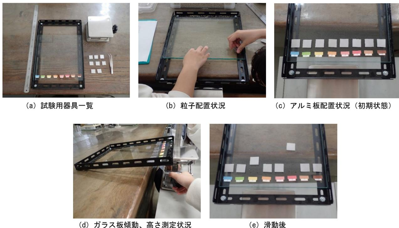
写真-1 粒子すべり角試験状況
