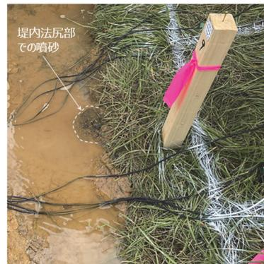
図 2-4 小規模噴砂の発生状況
